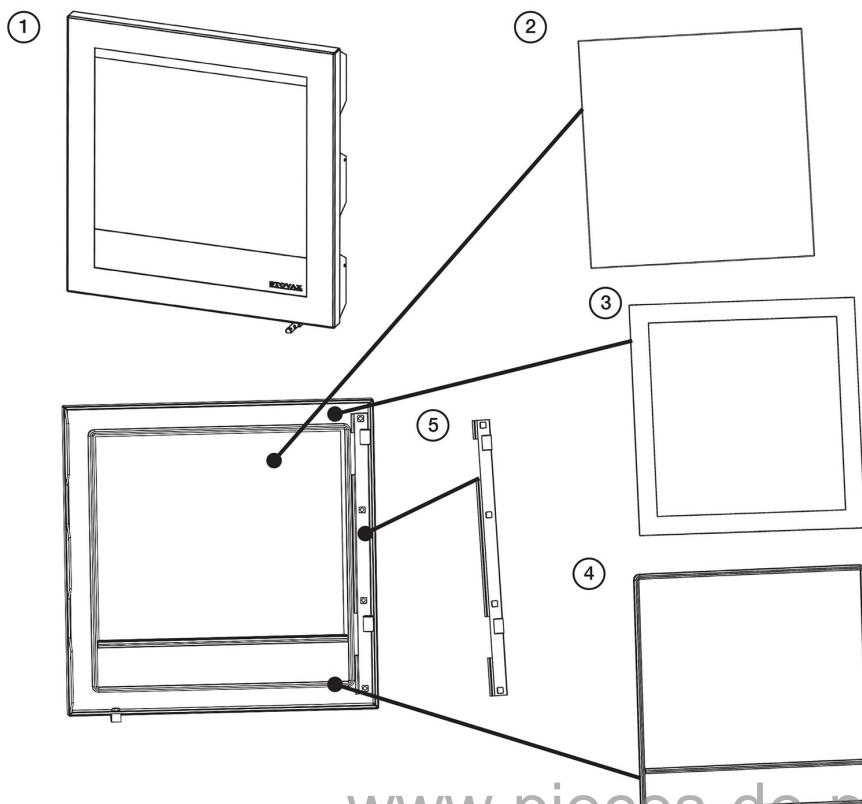
**Réf. Code produit Description**1 **MEC10461** Ensemble de porte complet en acier Elise 5402 **CE8147** Porte vitrée Elise 5402 **4267A** Mastic silicone - 75 ml3 **5705** Ruban adhésif 40 mm x 2 mm - Paquet de 3,4 m
